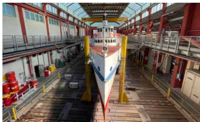
LE MANUTENZIONI SI SVILUPPANO SULLE PIATTAFORME DI ALAGGIO
